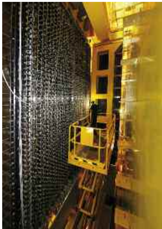
Un ingeniero coloca tubos fotomultiplicadores en el detector LHCb. Aquí se estudiará el quark bottom, a través de los fotones, electrones y positrones generados en su desintegración (CERN).
