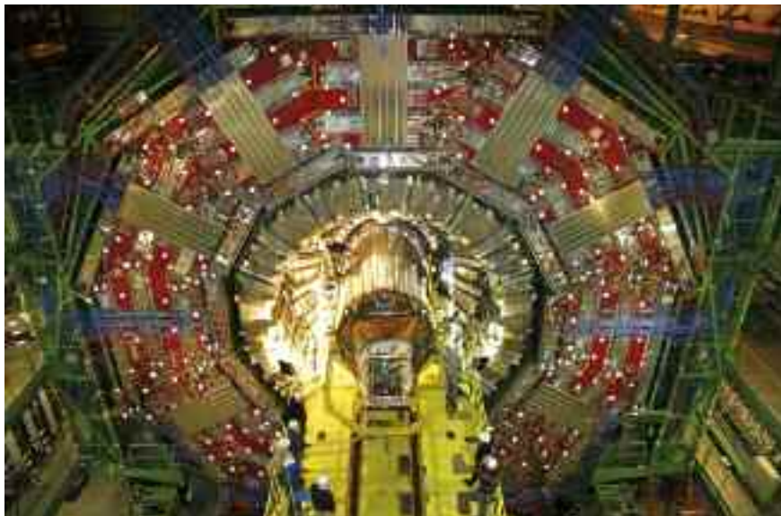
Un grupo de técnicos instala el detector CMS (CERN).
